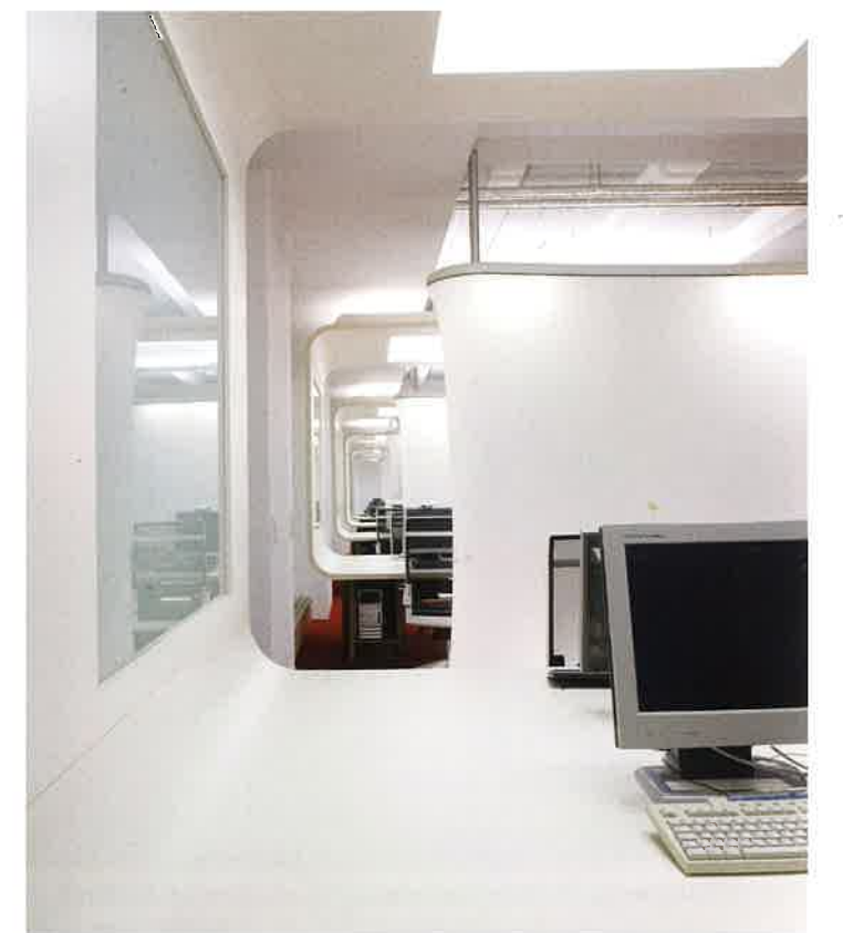
Skulpturale Objekte mit LED-Innenbeleuchtung aus einem Folienmaterial, das Schall absorbiert, verbessern die Raumakustik und trennen Arbeitsbereiche voneinander ab.
